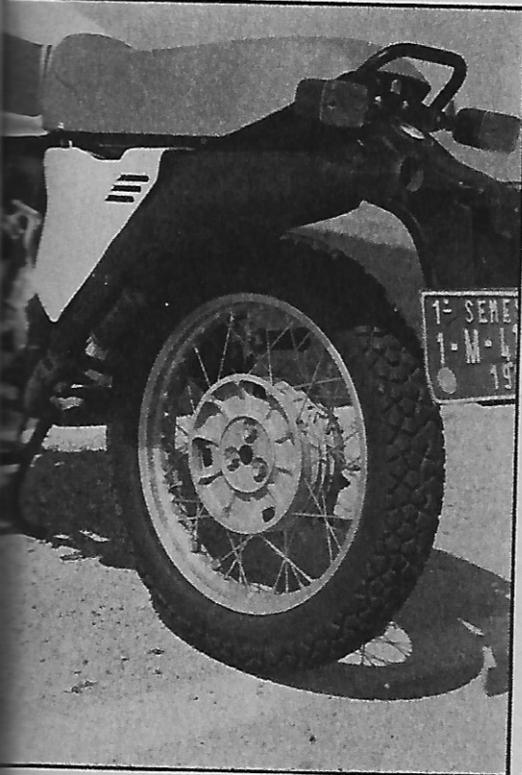
Para reducir peso se ha eliminado la mitad del basculante y uno de los amortiguadores. Una solución atrevida pero que da buenos resultados y sin problemas de estabilidad sobre asfalto a velocidades por encima de 160 km/h.
