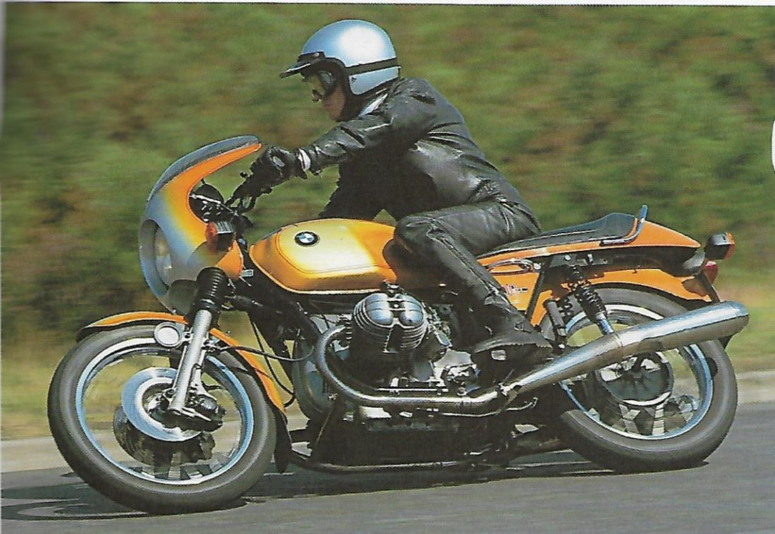
*Izquierda:* Aunque el chasis de la R90S se había fabricado pensando tanto en el confort como en la velocidad, el bastidor rígido y las suspensiones con una respuesta bastante correcta ofrecían un comportamiento fiable. Por desgracia, tenía un precio tan alto como las impresionantes características que ofrecía.
