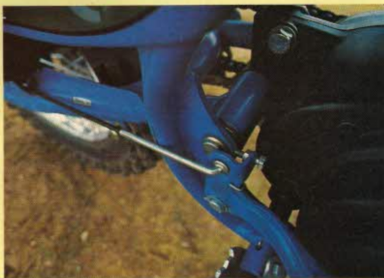
Obsérvese dónde va instalado el tensor de graduación de la posición del pedal del freno trasero.
