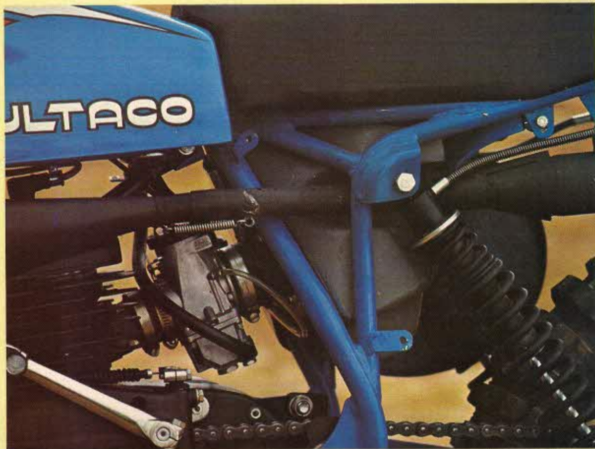
Detalle del carburador (ahora Amal), triangulación del chasis silencioso y punto de anclaje de los amortiguadores.
