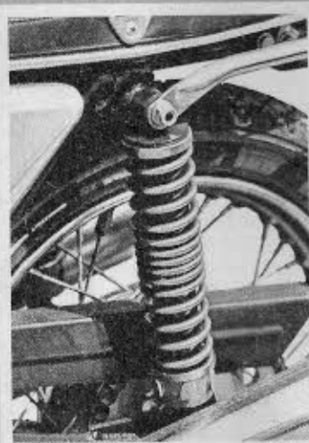
Esta Motobi equipa unos nuevos amortiguadores traseros que la hacen más estable que su hermana la Benelli 500; y por supuesto su confortabilidad no se ve perjudicada.
