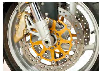
Para frenar incorporaba un equipo de primera en aquella época, doble disco delantero de 320 mm con pinzas Brembo Oro.
