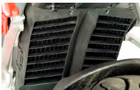
El radiador de refrigeración estaba situado bajo el asiento del piloto, un lugar inusual.
