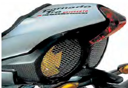
En el colín se instalaron un par de grandes electroventiladores para extraer el aire caliente del radiador.
