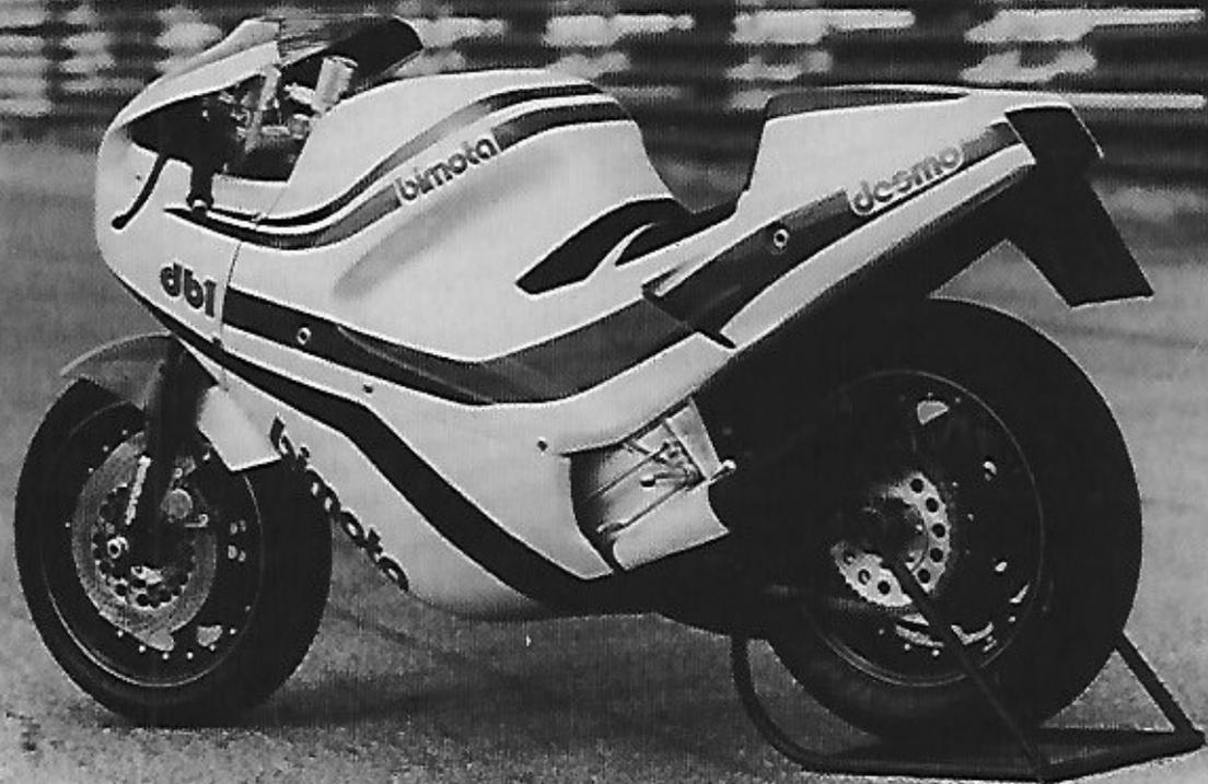
No hace falta resaltar el carácter exclusivamente deportivo de la nueva DB-1 de calle que se distingue de la de carreras por el faro y el piloto trasero. Los dos grandes cilindros situados a continuación de las barras de la suspensión delantera son los depósitos del líquido de freno y embrague (!).
