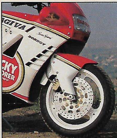
La frenada sigue confiada a unos Brembo de 298 mm. con pinza flotante de 4 pistones. Los neumáticos, unos MT 75 Pirelli, se muestran asimismo muy adecuados para una 125 "R" como ésta.
