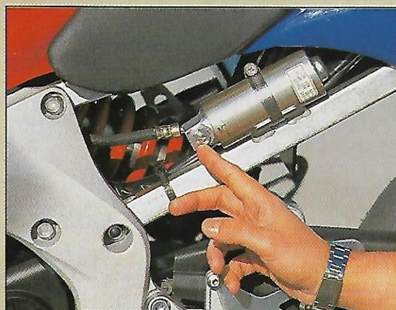
La regulación del amortiguador trasero queda mucho más a mano en la Honda. Justo debajo del cuko del conductor. El elemento amortiguante es regulable en 3 vías, al igual que el de la R6.
