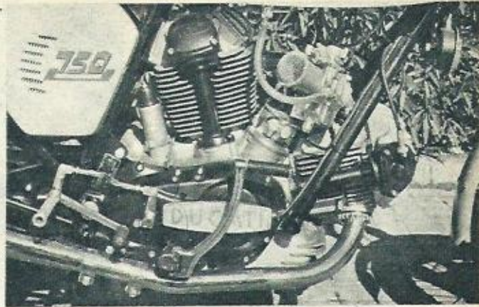
En el centro de los dos cilindros podemos ver el carburador del delantero, los ruptores y condensadores. Obsérvese el reenvío de la palanca de cambios.
