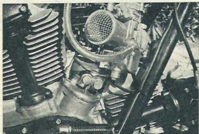
Detalle del carburador del cilindro delantero, Dell'Orto PHF 32, con bomba de aceleración. Se puede ver el alojamiento del árbol de mando de distribución a cada cilindro.
