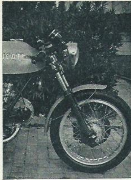
La horquilla es una Marzocchi, especialmente diseñada para Ducati. Freno de disco con mando hidráulico; se ha previsto todo para el montaje de un segundo disco.
