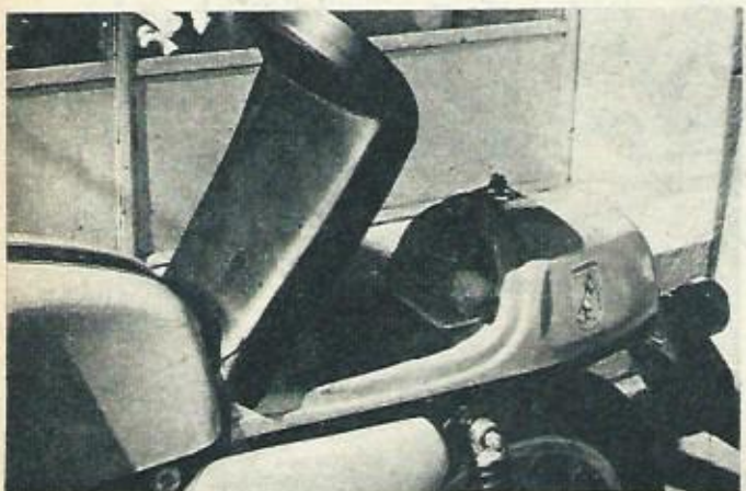
El sillín se levanta para descubrir un vasto cofre de herramientas. Equipado con cerradura de seguridad.
