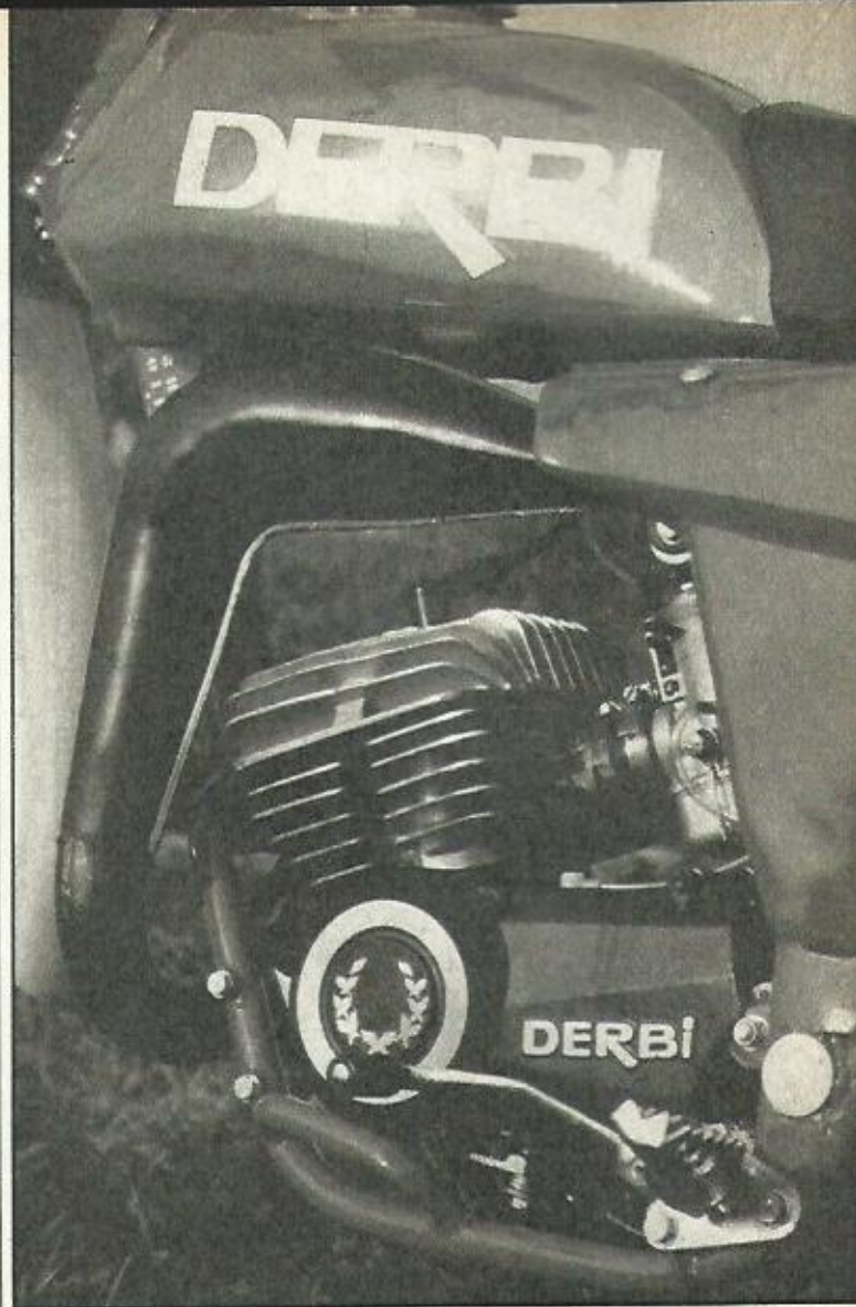
El motor, según fábrica, da 17 CV a 12.000 r.p.m.
