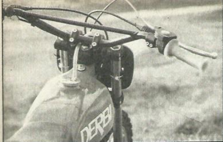
El depósito tiene una capacidad más que suficiente. En el manillar, puño de gas Tecnomoto y empuñaduras pentagonales.
