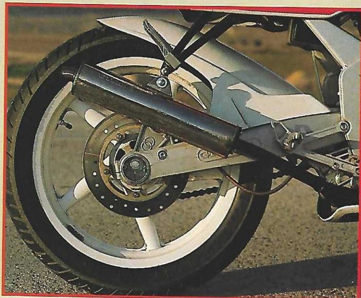
Grimeca de cinco brazos de la MXR en medidas 2,50x16 y 3,00x17. Los neumáticos, Michelin A39 y M39 en dimensiones 100/80x16 y 130/70x17. También es Grimeca el equipo de frenos: un disco anterior de 300 mm. y un posterior de 240, accionados por pinzas de cuatro y dos pistones, respectivamente.
