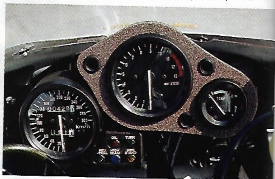
Instrumentación muy racing, con el tacómetro y el reloj de temperatura montados sobre espuma, los testigos agrupados y el velocímetro desmontable para competición.
