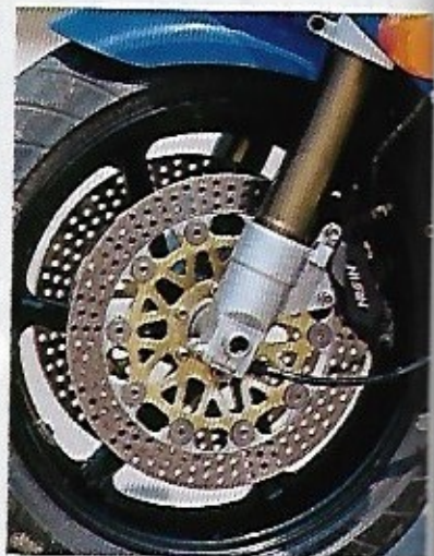
Delante montaba dos discos de 296 mm, con pinzas de 4 pistones.
