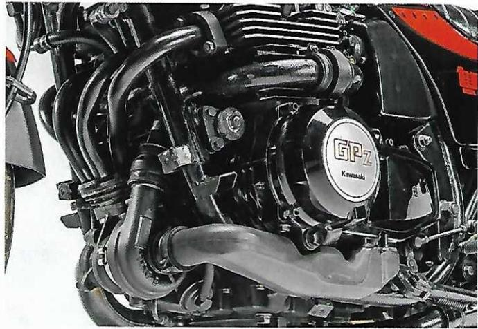
El turbo Hitachi estaba colocado por delante del cárter motor muy cerca de la salida de los colectores y tomaba el aire del filtro ubicado en el lado izquierdo del cárter.
