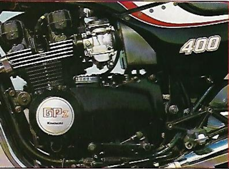
Motor agresivo, deportivo, el más rápido de la categoría en nuestro país. Cuatro cilindros, ocho válvulas, 50 CV. y 182 km/h. de velocidad punta.
