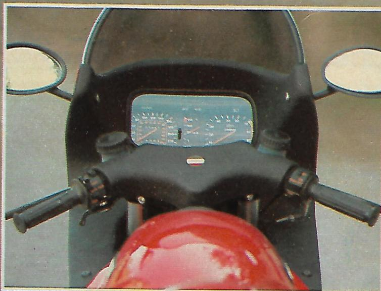
Aspecto del tablero de instrumentos de corte automovilístico, con nivel de gasolina y temperatura de aceite, además de los clásicos relojes cuentakilómetros y cuentavueeltas.
