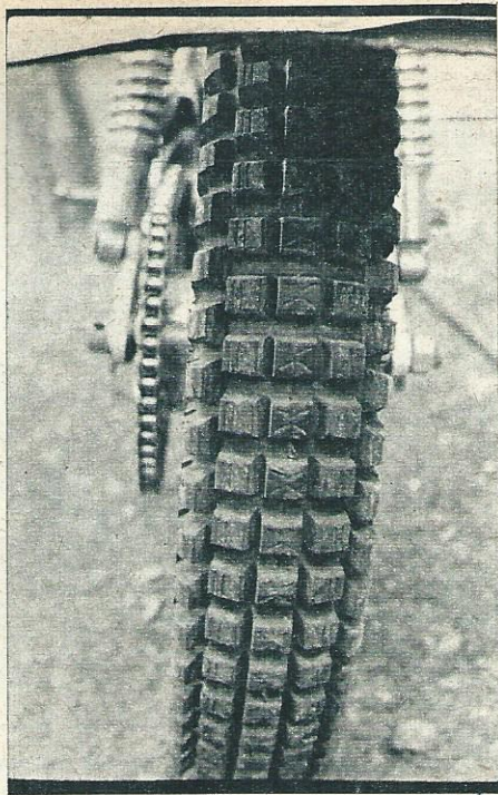
Nuevo neumático de 2,50 x 20 y 3,75 x 17 (Pirelli) para este modelo, tipo trial de dos lonas, que le proporcionará un excelente comportamiento en terreno fangoso.
