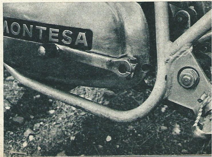
Con vistas a la exportación, la palanca de cambios ha sido colocada en la parte izquierda.
