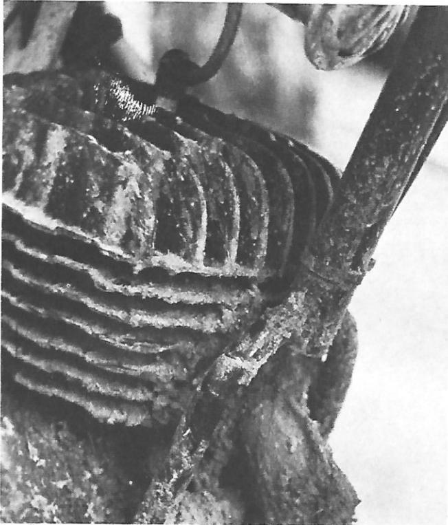
*Si al guardabarros delantero le colocamos una prolongación, evitaremos que el cilindro se llene de barro, con el lógico beneficio en refrigeración.*
