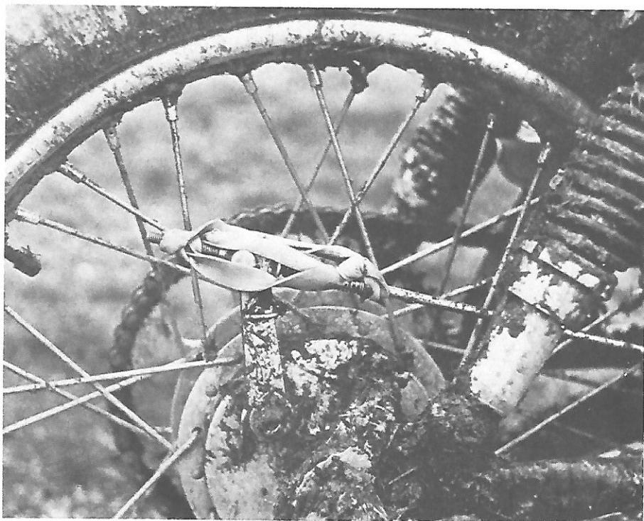
Por medio de bandas elásticas, podemos evitar que la palomilla que tensa la varilla del freno trasero se afloje.
