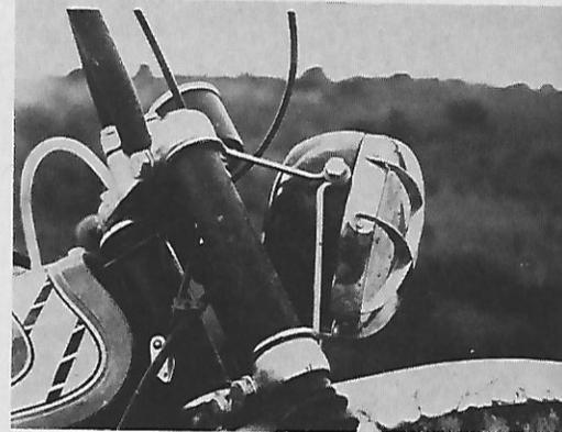
*Para mantener en posición correcta la matrícula y el piloto trasero, el soporte de goma lleva por su parte trasera un refuerzo metálico. El faro delantero va montado en un sistema de varillas muy similar al de la Cota 348, y lleva una rejilla para proteger el cristal. El caudal de luz que proporciona, aunque escaso, es superior a otras máquinas de este tipo que hemos probado.*
