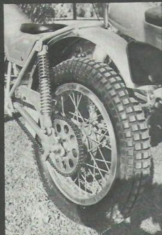
Conjunto de la suspensión trasera; el anclaje del amortiguador es diferente al de la Cota 247. Ha sido suprimido el depósito de aceite para engrase de la cadena.
