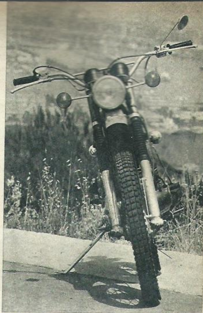
Vista de frente, la máquina es recogida, sobresaliendo solamente por su parte izquierda el mecanismo de mezcla automática del motor. Debajo, vista trasera. Los intermitentes son de fábrica.
