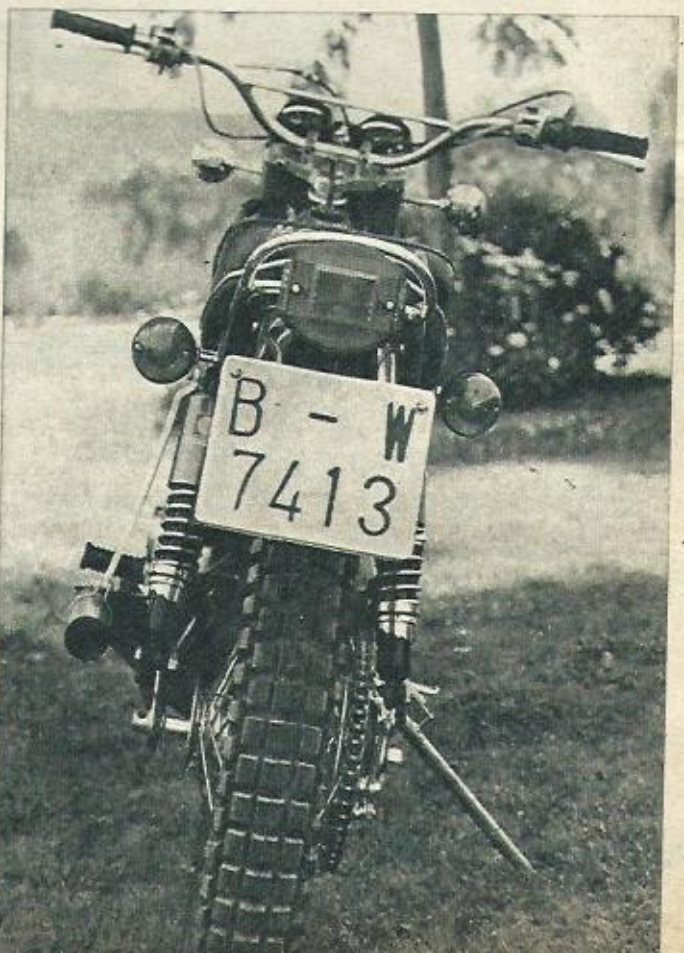
Vista de frente, la máquina es recogida, sobresaliendo solamente por su parte izquierda el mecanismo de mezcla automática del motor. Debajo, vista trasera. Los intermitentes son de fábrica.
