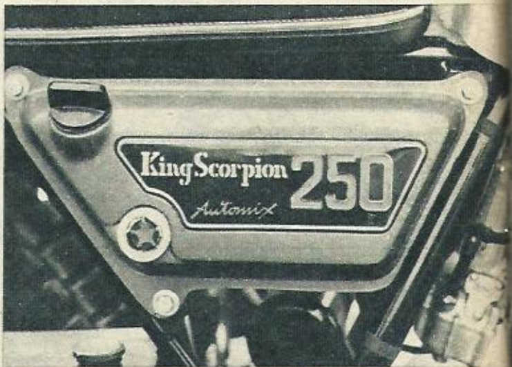
Del lado contrario a la batería va el depósito de aceite, con indicador de nivel.
