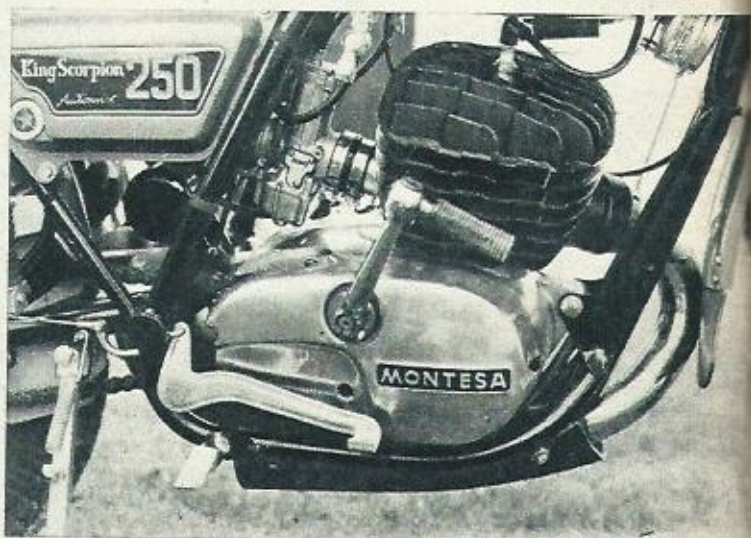
Motor de 250 c. c., con aletas onduladas, equipado con un carburador Bing de 32 mm., montado elásticamente.
