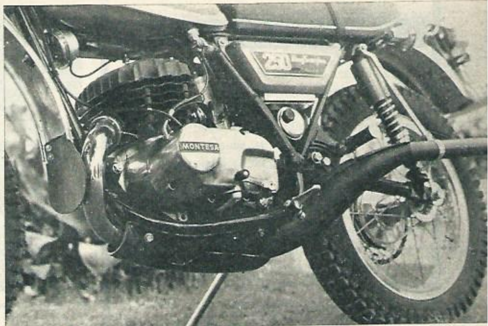
El tubo de escape va perfectamente acoplado por su parte inferior y protegido con una plancha contra los accidentes del camino,
