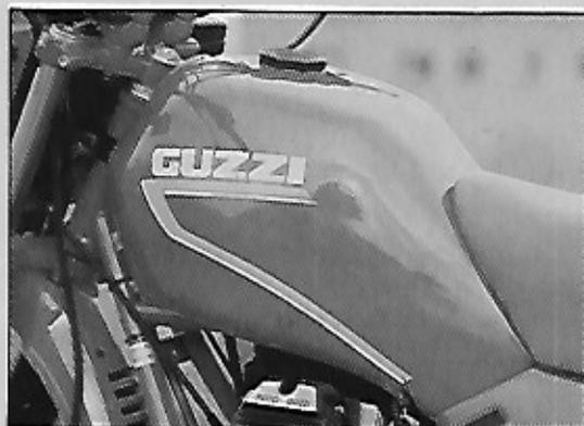
Depósito tipo Enduro, con muy buen acabado de pintura y tapón con cierre a llave.
