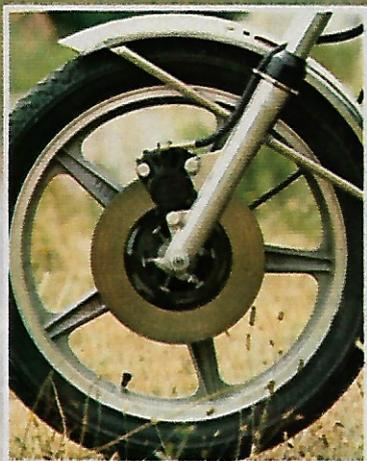
Las nuevas llantas y frenos AJP (disco 260 mm. delante) proporcionan una nueva imagen, así como una excelente frenada.
