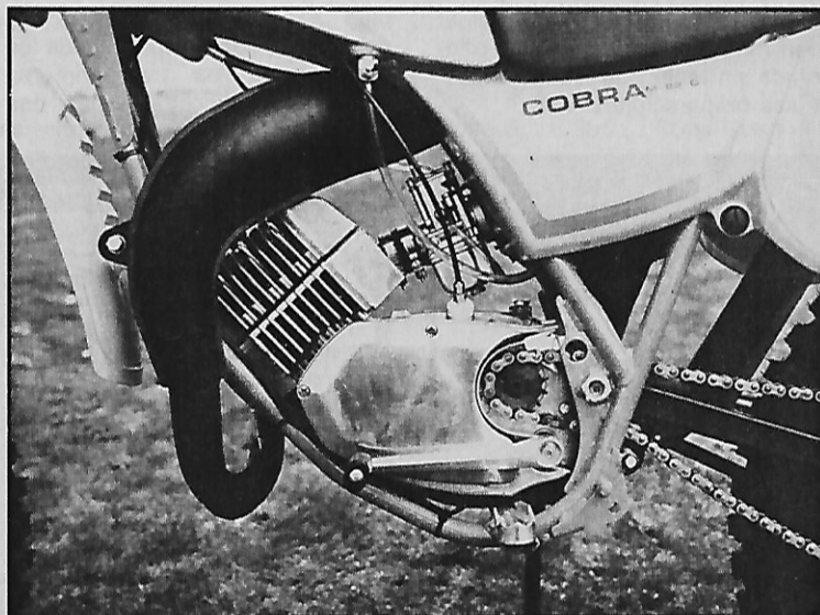
El tubarro forma difusor desde la salida del cilindro. El motor mantiene el aspecto habitual.
