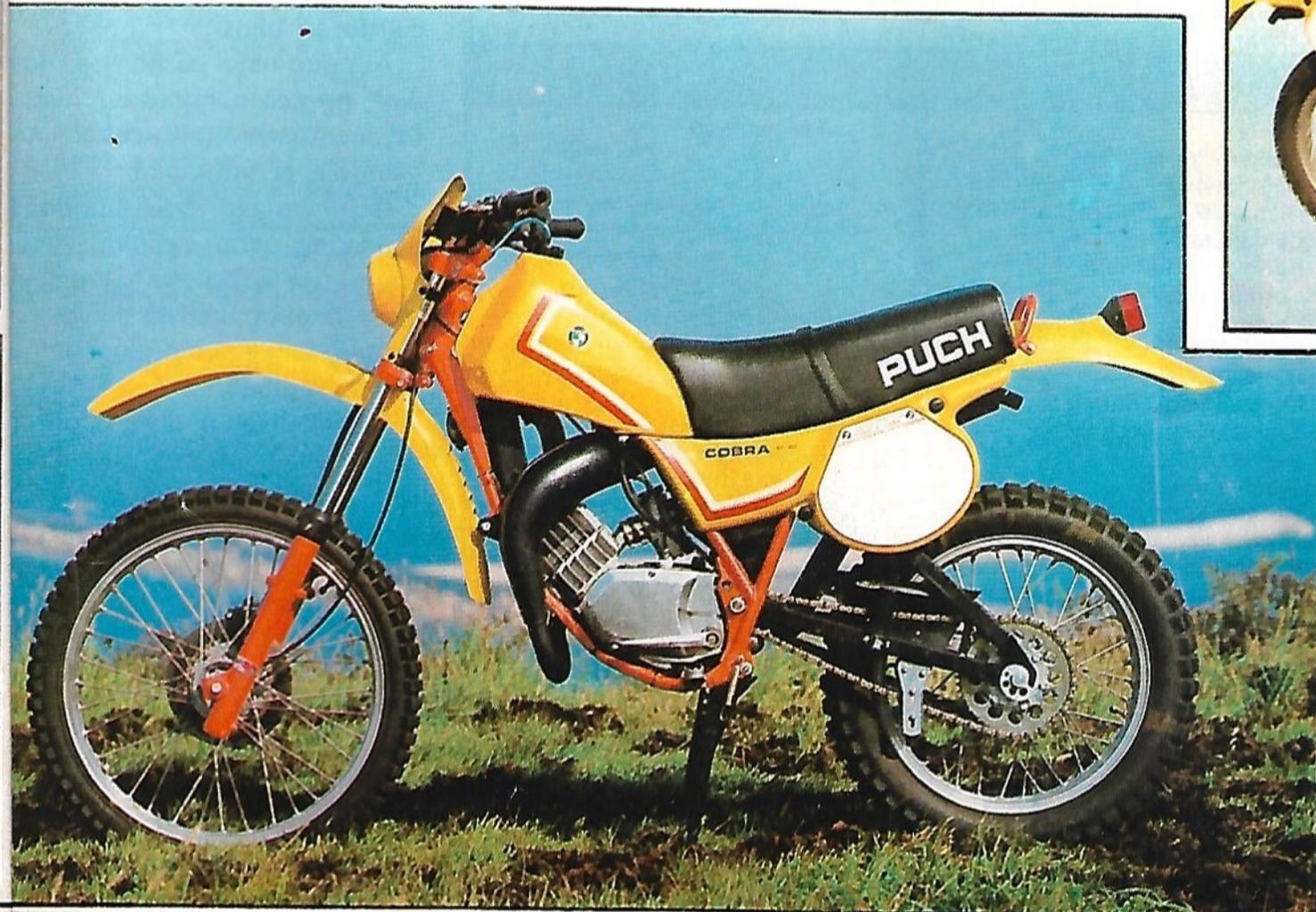
La Cobra M-82, una moto con un motor menos apretado que su compañera, con carburador Amal de 25 milímetros de diámetro.
