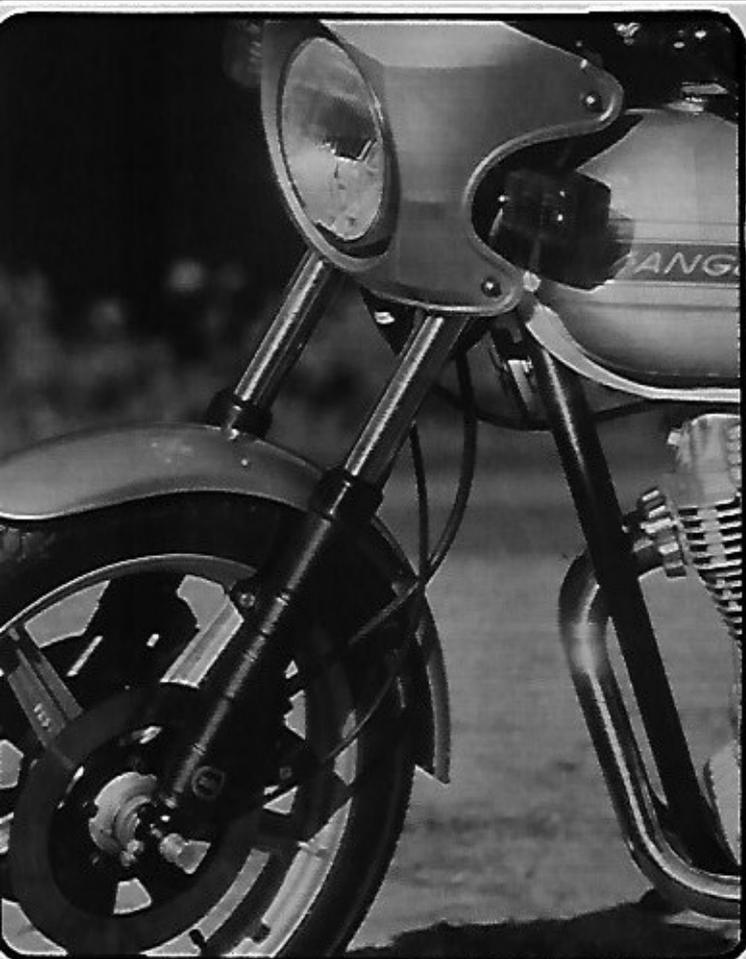
La horquilla delantera es Telesco la cual contribuye al buen funcionamiento de la estabilidad en general. La óptica H-4 halógena produce con la luz larga la suficiente luminosidad como para sacarle todo el partido a esta moto
