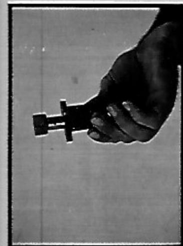
Este es el tensor automático de la cadena de distribución. Funciona mediante un muelle y un trinquete que evita el que cada punto ganado de tensión pueda retroceder
