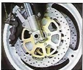
Los discos están firmados por Brembo son ahora de 5 mm. de grosor y han ganado dos puntos de anclaje. Las pinzas son de seis pistones.
