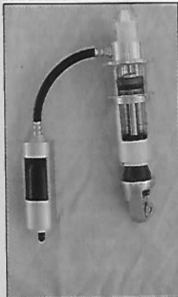
*La nueva horquilla con anti-dive eléctrico NEAS a la derecha y el amortiguador del Full Floater a la izquierda.*
