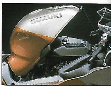
El depósito bascula para acceder fácilmente al filtro del aire.
