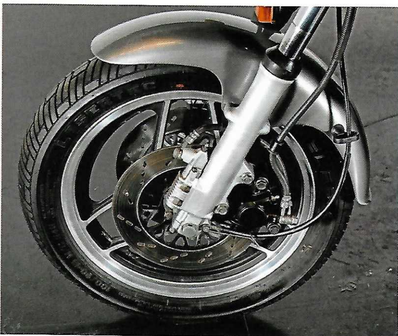
La llanta delantera era de 16", la primera moto de serie en equiparla, que la dotaba de una tremenda agilidad en tramos revirados.
