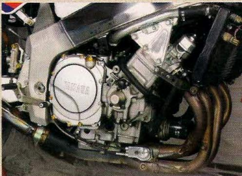
**La Yamaha OW01 tenía todo lo que una moto de carreras necesitaba.** El motor con menos ángulo permitía cargar más peso delante y tenía cotas internas más radicales. El chasis con piezas fundidas disponía incluso de un amortiguador Öhlins, algo insólito en su época.
