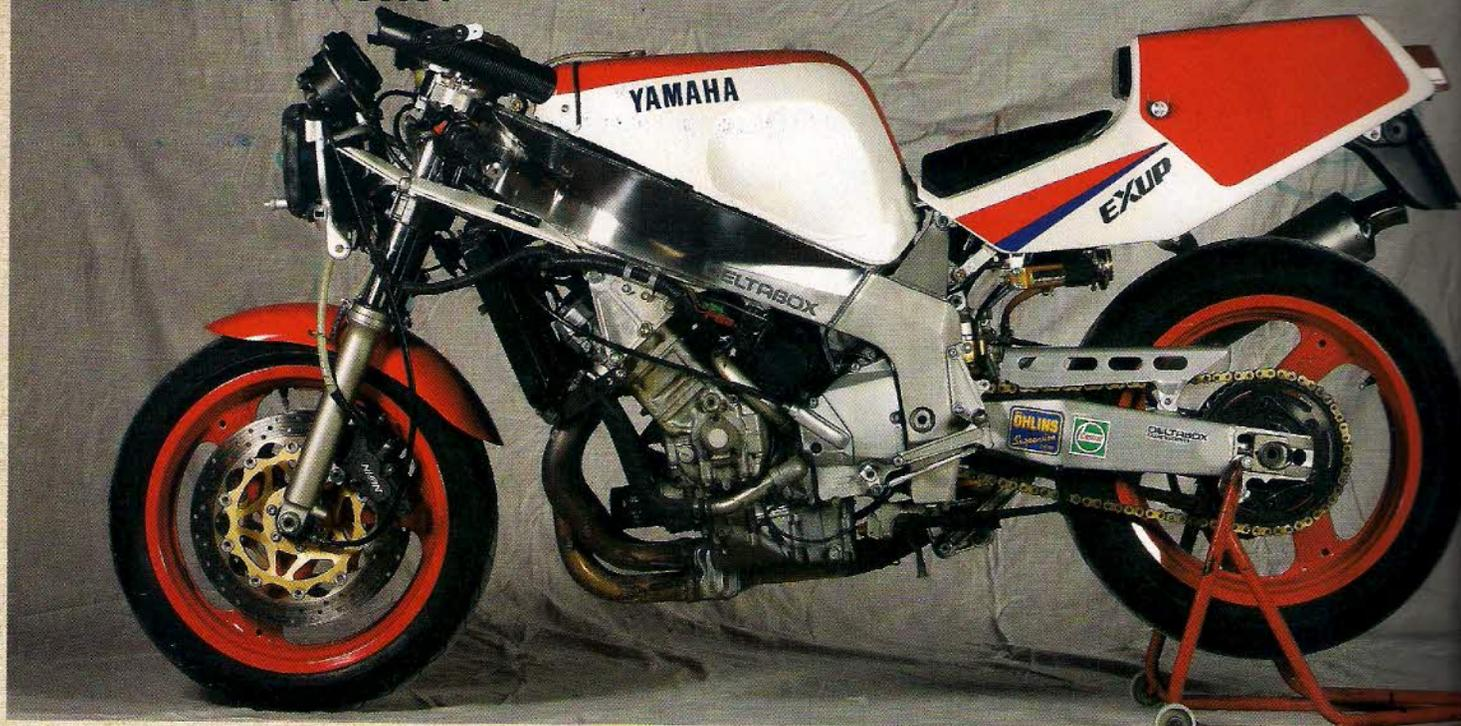
La OW01 no planteaba diferencias de concepto con los modelos deportivos contemporáneos de la firma, que seguían las directrices marcadas inicialmente por la FZ 750 y posteriormente por las FZR 1000 y FZR 750, ya con chasis doble viga de aluminio, las primeras de la marca. No obstante, este modelo se había creado como base para competir en los diferentes campeonatos y no como una moto para ir por la calle, para lo que ya había otras versiones.
