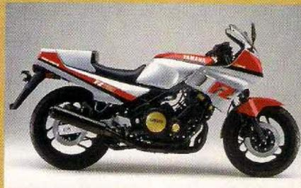
**1985 FZ 750.** La llegada de la FZ 750 supuso toda una revolución en Yamaha. Se estrenan las culatas de cinco válvulas y el motor tiene los cilindros inclinados y refrigeración por agua. Respecto a las anteriores XJ se gana en potencia y se reduce el peso creando la primera gran deportiva de cuatro tiempos de la firma.
