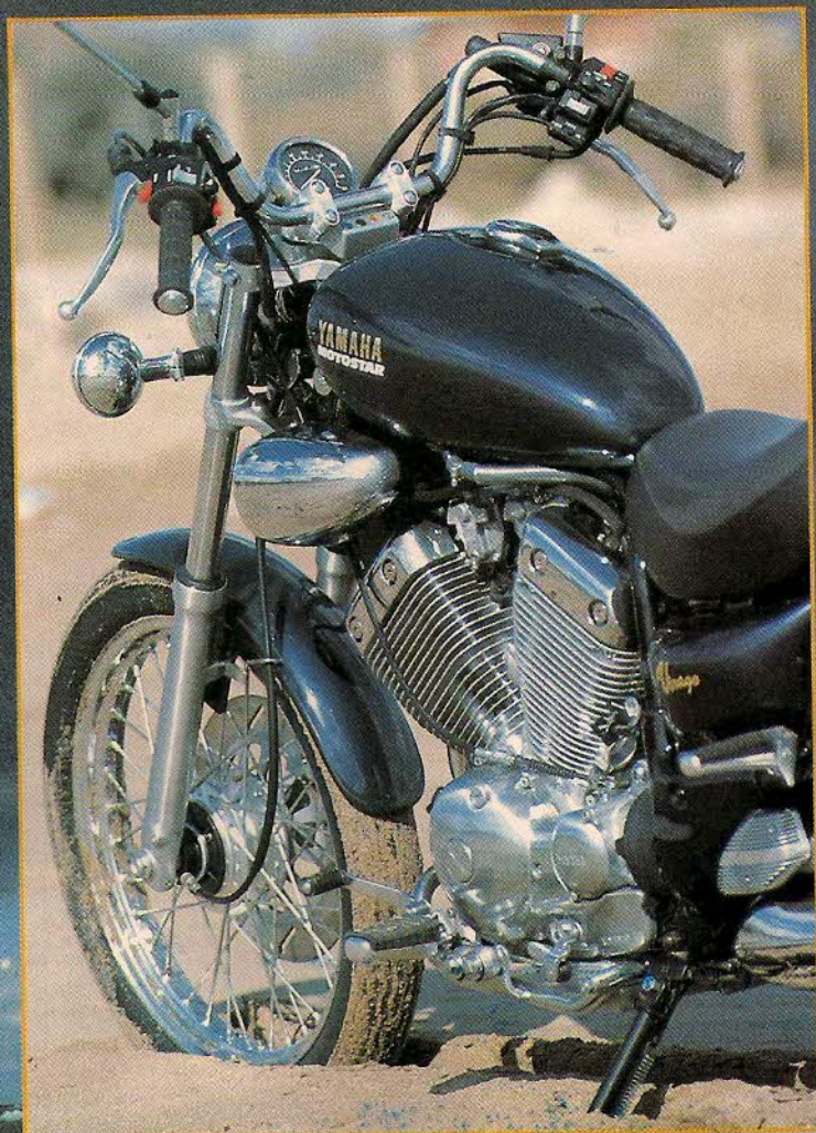
Suavidad, pocas vibraciones y potencia a cualquier régimen caracterizan al sencillo y muy efectivo motor bicilindrico en V de la Virago.
